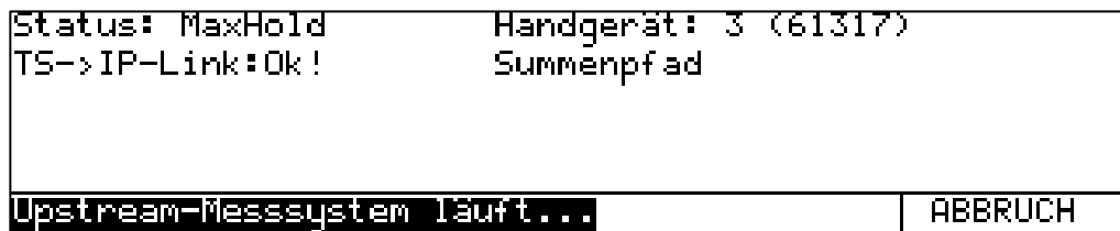
Abbildung 6-17 LC-Display bei MAX-HOLD-Anforderung durch ein Feldgerät im Summenmodus
