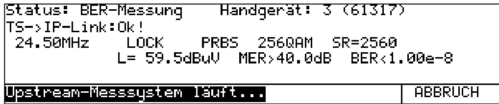
Abbildung 6-11 LC-Display bei MER/BER-Messung durch ein Feldgerät
