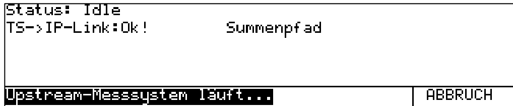
Abbildung 6-15 Startanzeige des LC-Displays im Summenmodus des SW 024 (TS-Ausgang über IP)
