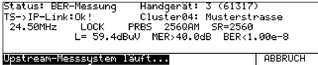
Abbildung 6-19 LC-Display bei MER/BER-Messung durch ein Feldgerät an Switch-Eingang 4
