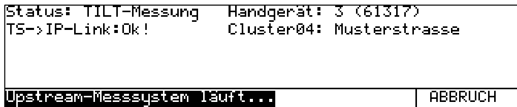
Abbildung 6-20 LC-Display bei TILT-Messung durch ein Feldgerät an Switch-Eingang 4
