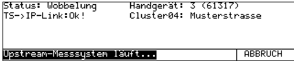
Abbildung 6-18 LC-Display bei Wobbelmessung durch ein Feldgerät an Switch-Eingang 4
