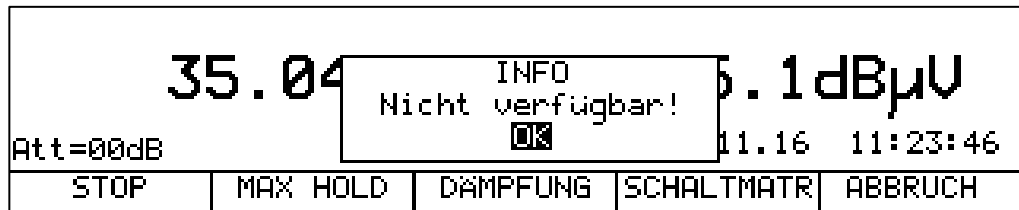
Abbildung 7-15 Eingangswahl im Analyzer-Betrieb mit Switch SW 024 ohne angeschlossenen Switch
