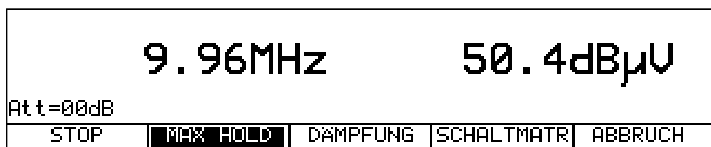
Abbildung 7-5 Aktivierung der MAX-HOLD-Funktion im Echtzeit-Analyzer
