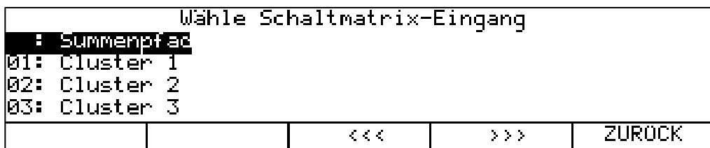
Abbildung 7-13 Analyzer-Betrieb mit Switch SW 024: Eingangswahl
