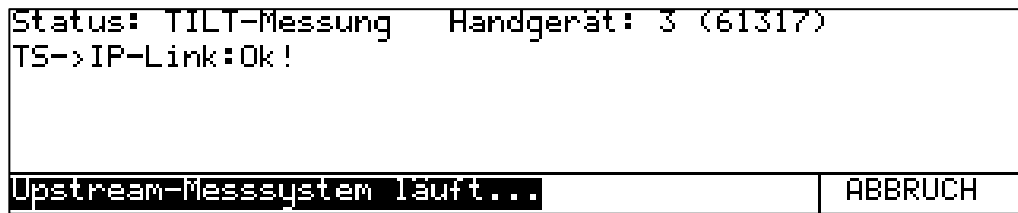
Abbildung 6-13 LC-Display bei TILT-Messung durch ein Feldgerät
