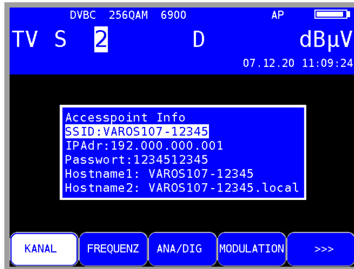
Abbildung 26-5 Access-Point Informationen nach Standardwerten
