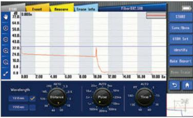
Der OTDR-Modus misst Entfernung, Verlust, Reflektivität, Dämpfung und Akkumulationsverlust auf einer Glasfaser Verbindung.
