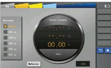
OPM wird zum Messen des absoluten optischen Leistungsmessers oder des relativen optischen Leistungsverlusts über die Spanne der optischen Faser verwendet.
