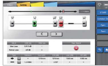
SOLA ist eine Anwendung für das OTDR zur Vereinfachung des Testprozesses, ohne dass Parameter oder Analysen konfiguriert werden müssen, während mehrere komplexe OTDR-Kurven analysiert werden.
