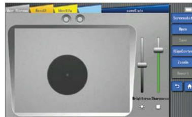
Der Faserendtester (Peripheriegerät erforderlich) wird hauptsächlich zum Testen der Sauberkeit und Glattheit der Faserendfläche verwendet.
