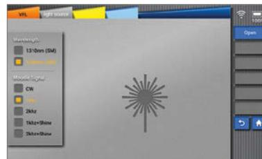
Eine unsichtbare Lichtquelle (1.310/1.550 nm) kann die folgenden Lichtquellen liefern: CW, 1 kHz, 2 kHz moduliert und 1 kHz & 2 kHz Blinken.
