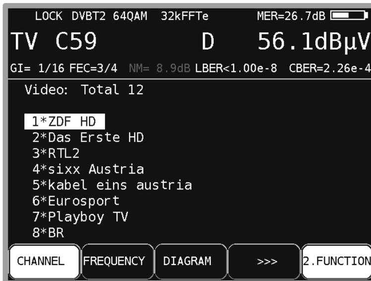
Figure 7-22 DVB-T2 parameters
