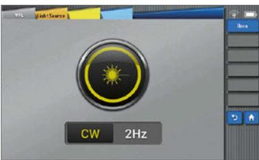
Der VFL (Visual Fault Locator) identifiziert die Position des Biegepunkts, des fehlerhaften Steckverbinders oder des Spleißpunkts visuell, indem er einen hellroten Laser aussendet (dieser kann maximal 10 km erreichen). Dies ist ein Muss für die Mitarbeiter vor Ort.
