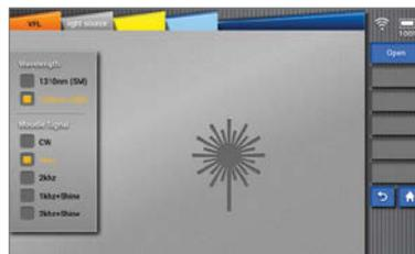
Eine unsichtbare Lichtquelle (1.310/1.550 nm) kann die folgenden Lichtquellen liefern: CW, 1 kHz, 2 kHz moduliert und 1 kHz & 2 kHz blinkend.
