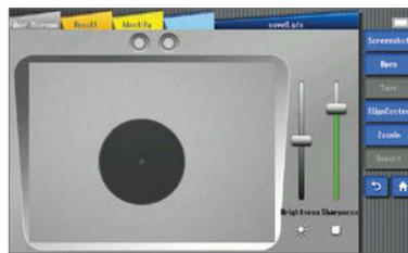
Das Testen der Faserendfläche an Steckverbindern mit einem Fasermikroskop ist sehr wichtig, da ein verschmutzter oder beschädigter Steckverbinder die Testergebnisse und den Testanschluss kritisch beschädigen kann.
