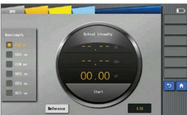
OPM wird zum genauen Messen der optischen Leistung in Glasfasernetzen verwendet, die bei 850 nm, 1.300 nm, 1.310 nm, 1.490 nm, 1.550 nm, 1.610 nm und 1.625 nm betrieben werden.
